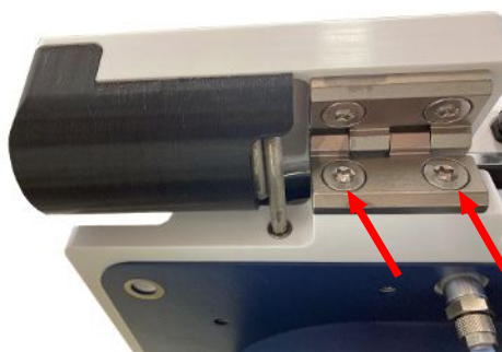
Obr. 14: Montáž na spodní držák membrány
