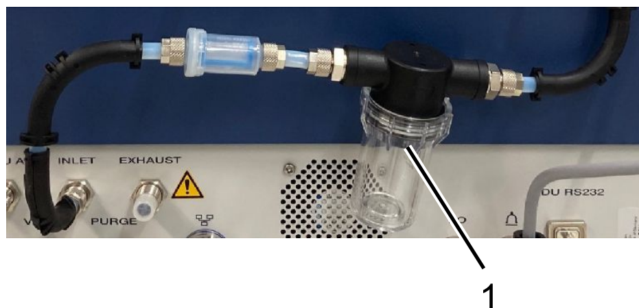
Obr. 10: Kontrola odlučovače kapaliny
