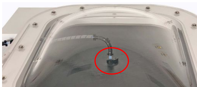
Obr. 6: Západkové svorka na horní straně měřicí komory
