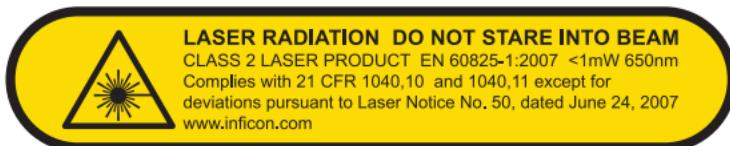
Whisper comprend un pointeur au laser intégré. Il est important de respecter les avertissements et instructions de sécurité suivants afin d'éviter un accident :
