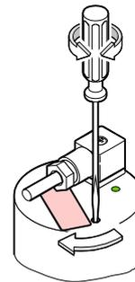
Using the 1.5 mm screwdriver, adjust the <ATM> potentiometer ...
