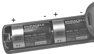
Figura 1. Pilas alcalinas debidamente instaladas
