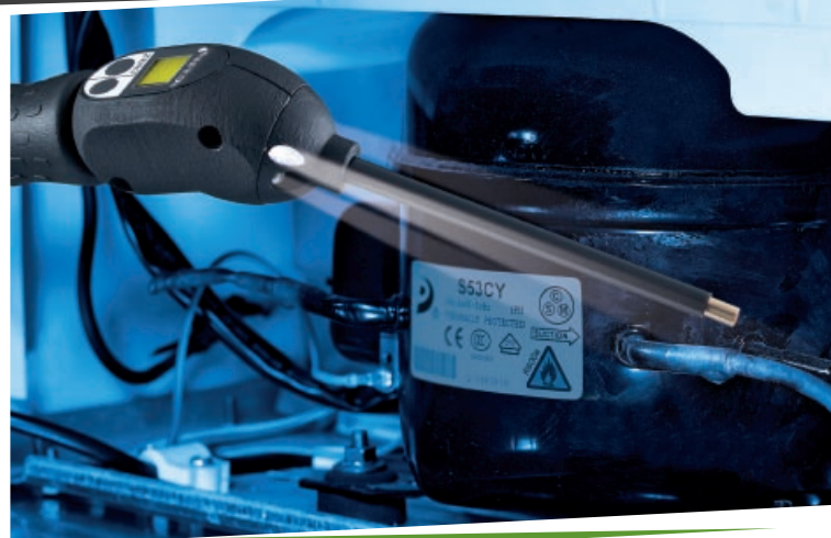
Une lampe intégrée aide à détecter les fuites
